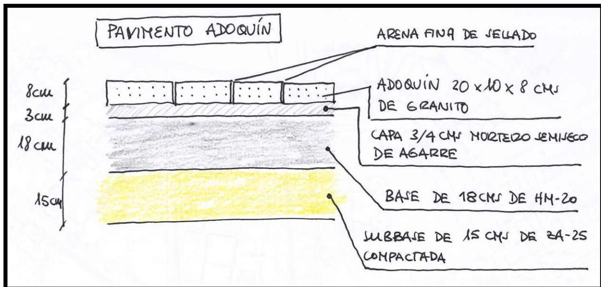
**Imagen 1:** croquis del detalle del pavimento de adoquín
